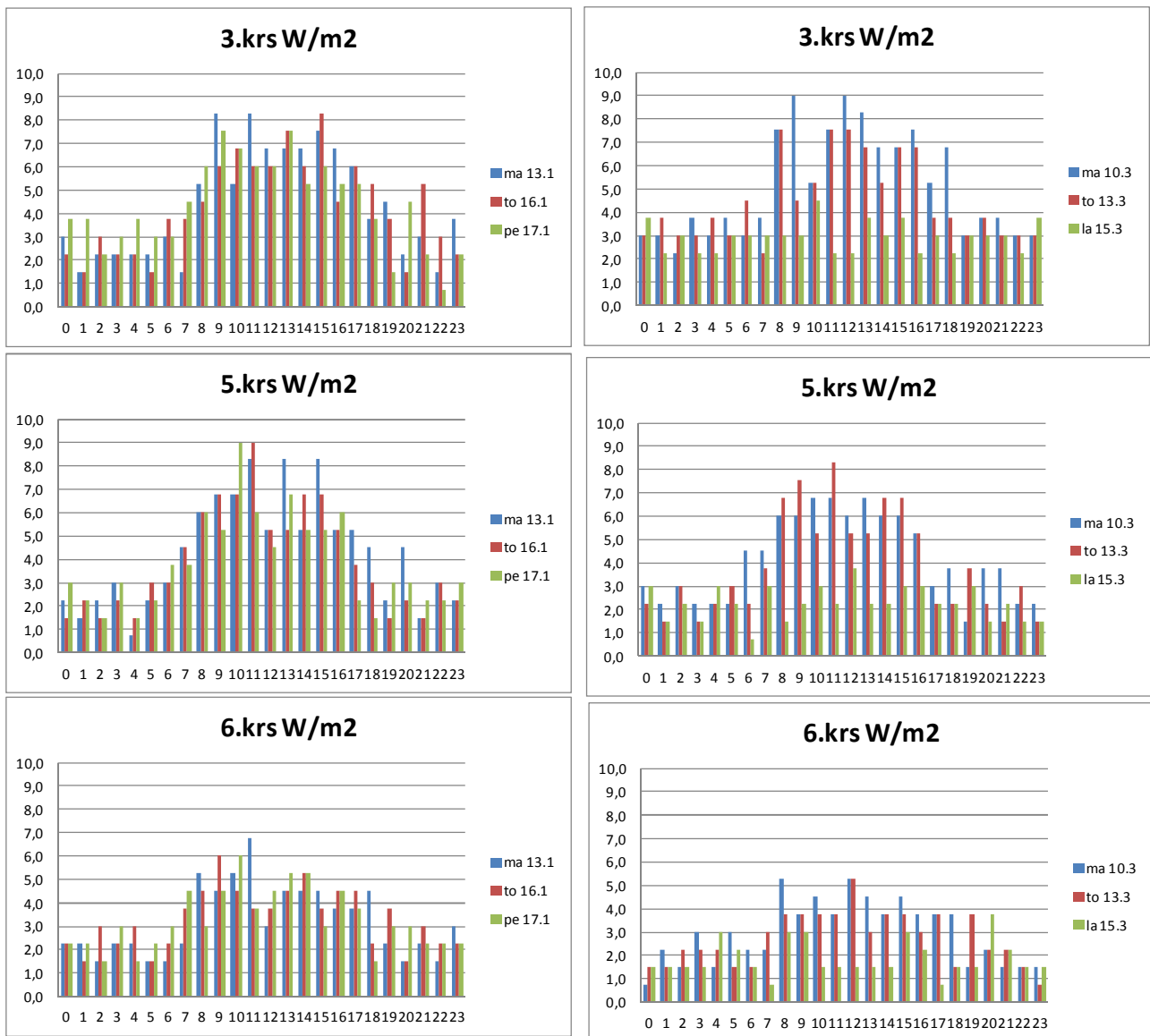
Kuva 6 Toimistotilojen pistorasiakuorma kolmessa eri kerroksessa kolmena eri päivänä
